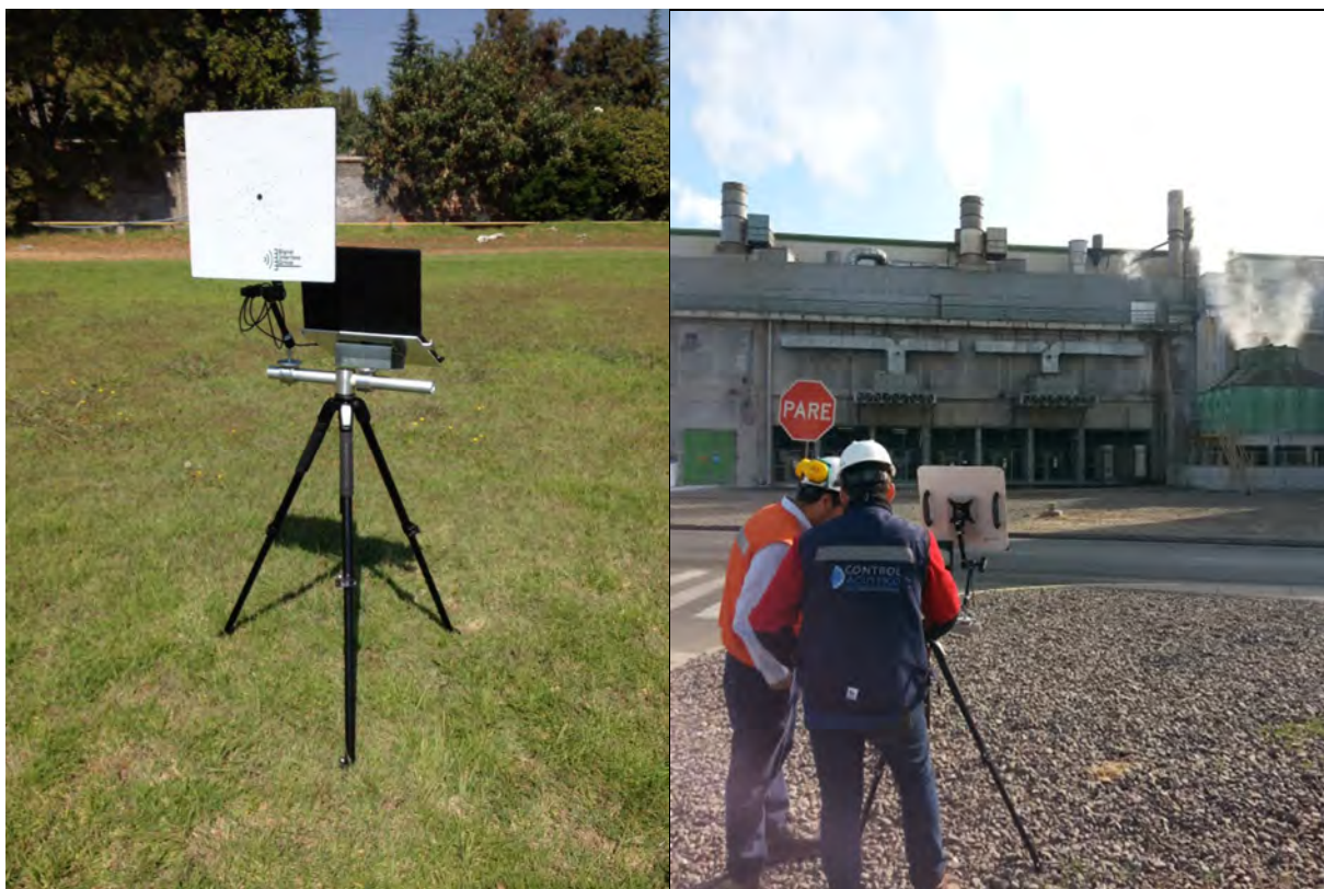
Ilustración 1: Operación en terreno de SIG Acoustic Camera y ejemplo visual de determinación de fuente de ruido.
